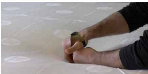
Piquage à l'aide d'une aiguille à travers le matelas
