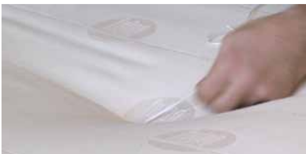
Piquage à l'aide d'une aiguille à travers le matelas
